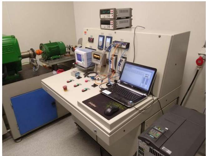
Medição de grandezas elétricas (V, I, P, f): Analisador Yokogawa WT500 com 3 TCs 50:5 A
