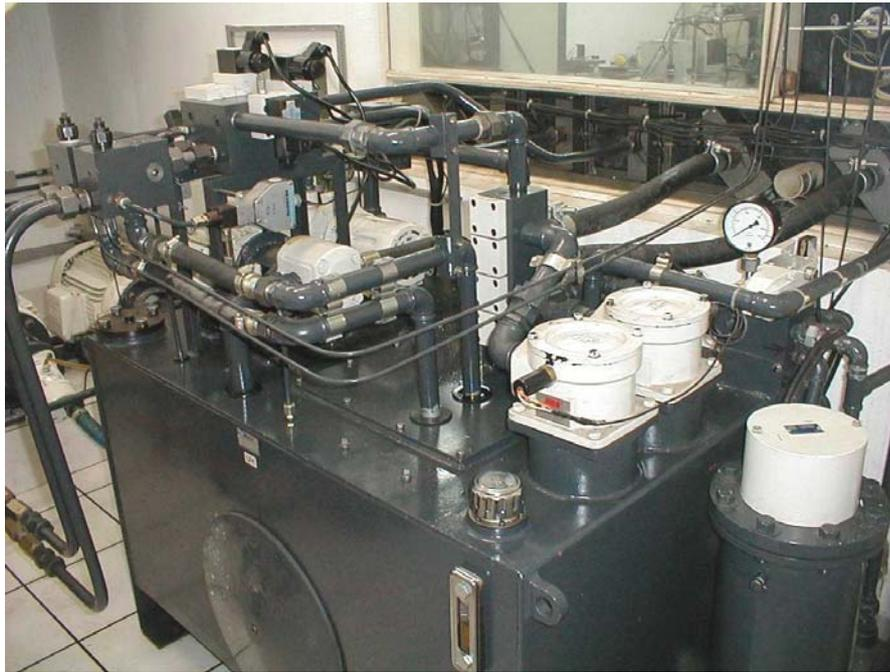
Figura 2.1 – Unidade de potência e condicionamento hidráulico – UPCH
