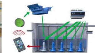
Figura 1 – Instalação de monitoramento on-line em estação de bombeamento.
