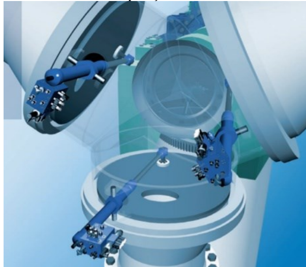
Figura 2.9 - Cilindros hidráulicos controlando posição da alavanca.
