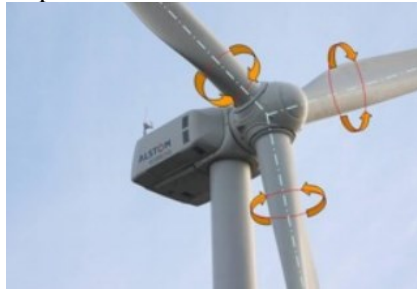
Figura 2.8 - Ilustração do ângulo de passo numa turbina eólica.
