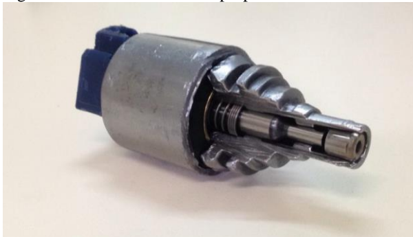
Figura 4.9 - Válvula solenoide proporcional normalmente aberta.
