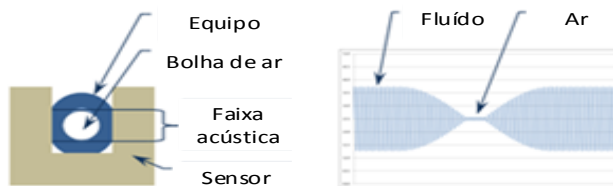
Figura 2.9 - Sensoriamento bolha de ar (a) e respectivo sinal (b).
