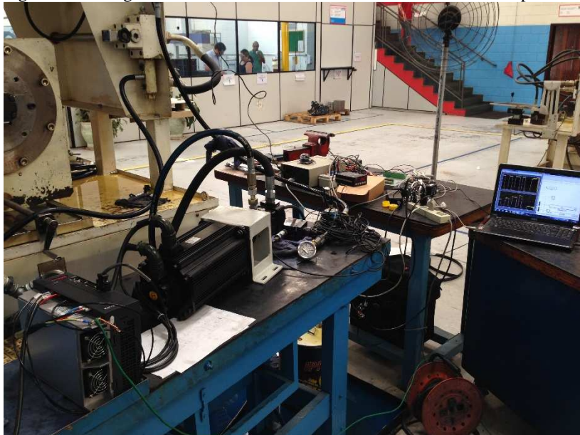
Figura 4.3 – Imagem do ensaio realizado sobre acionamento hidráulico primário
