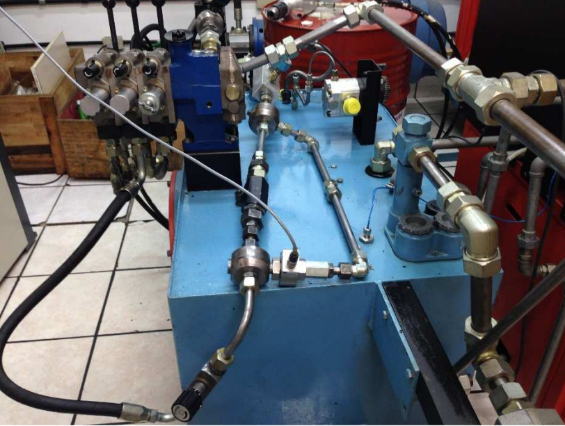
Figura 4.5 – Imagem do ensaio para a caracterização das válvulas de retenção
