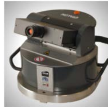
Laser Tracer: até 10 m, incerteza: 3 \mu\text{m}
