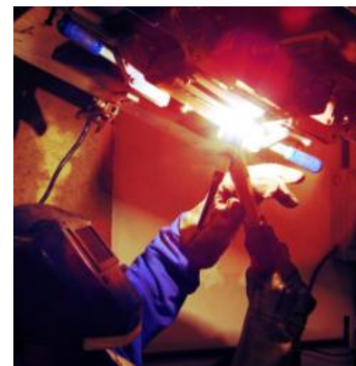
Aplicação de tecnologia PTA-P em Regiões de Turbinas Hidráulicas Sujeitas à Erosão por Cavitação
