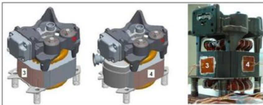
Instrumentação de um compressor com sensores de fluxo de calor.
