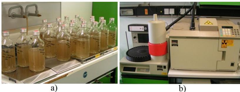
Figura 21. Testes de biodegradabilidade. a) amostras em frascos de vidro, b) Cromatógrafo de gás
