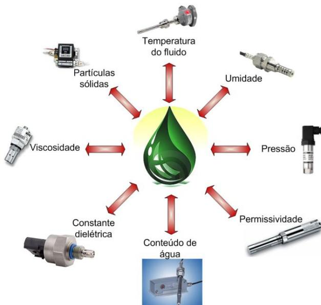
Figura 61. Tipos de sensores
