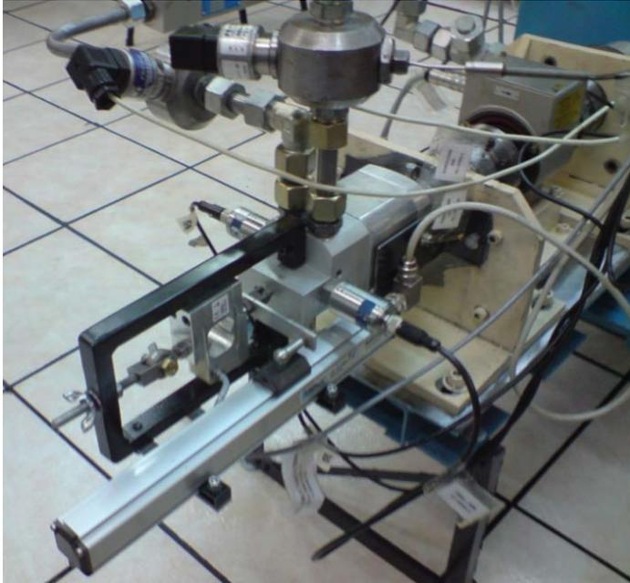
Figura 6.3: Protótipo da furadeira montada na bancada de ensaios.
