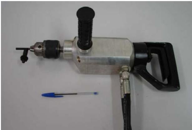
Figura 2.1: Modelo original da furadeira hidráulica.
