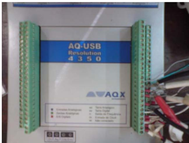
Figura B.7: Placa de aquisição de sinais AQ-USB Resolution 4350.
