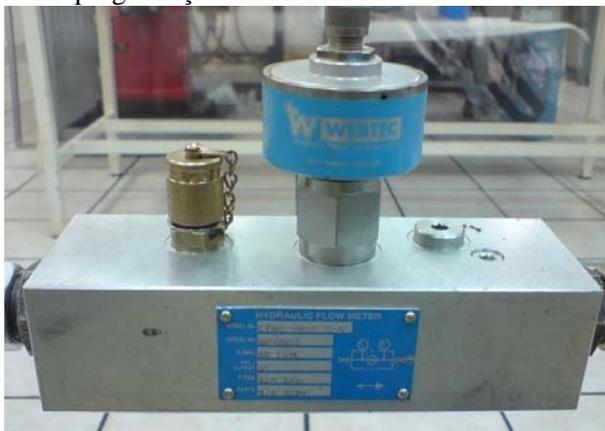
Figura B. 5: Transdutor de Vazão.
