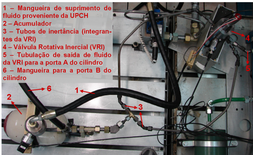
Figura 7.8 – VRI e demais componentes da bancada de testes.
