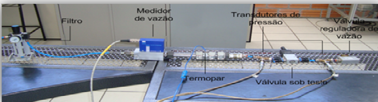
Figura 3.5 - Ensaio segundo Norma ISO 6358
