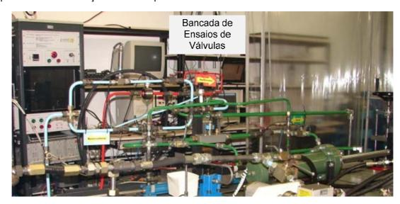
Figura 20 – Bancada de ensaio de válvulas.
