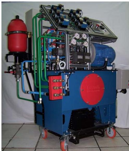
Figura 6.1 – UPCH – Unidade de potência e condicionamento hidráulica
