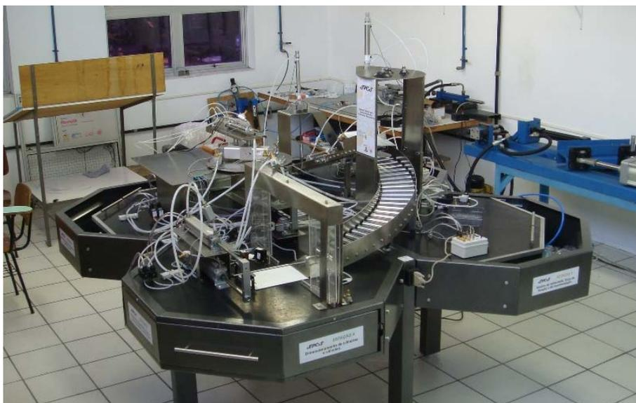
Figura 7.1 - Bancada didática para dimensionamento de sistemas pneumáticos - SPCS
