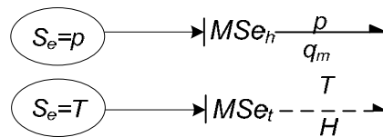
Figura 2.25 - Fonte modulada de pressão e temperatura.
