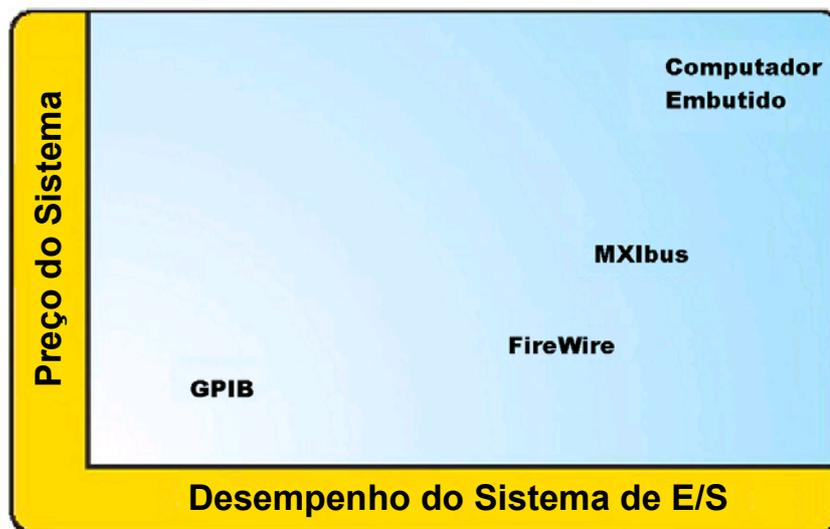
Figura 3.3 – Desempenho versus custos dos sistemas VXI (AGILENT TECHNOLOGIES, 2001).
